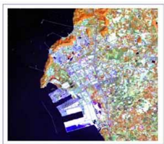
ภาพที่ 2 ภาพผสมสีเท็จจากดาวเทียมแลนด์แซท 5 ระบบทีเอ็ม (4 แดง, 5 เขียว, 3 น้ำเงิน) รายละเอียด 30 เมตร
